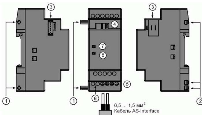
Все модули LOGO! монтируются на 35 мм профильную шину DIN или на плоскую поверхность. Объединение всех модулей в единое устройство осуществляется через внутреннюю шину. После модуля LOGO! CM не могут устанавливаться модули LOGO! DM8 230R и LOGO! DM16 230R. Модуль LOGO! CM рекомендуется устанавливать последним в линейке модулей расширения.
