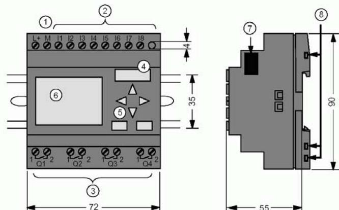
Все модули LOGO! монтируются на 35мм профильную шину DIN или на плоскую поверхность. Объединение всех модулей в единое устройство осуществляется через внутреннюю шину.
