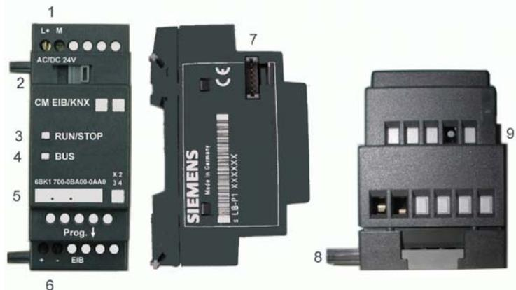
Все модули LOGO! монтируются на 35 мм профильную шину DIN или на плоскую поверхность. Объединение всех модулей в единое устройство осуществляется через внутреннюю шину. В линейке модулей расширения модуль LOGO! CM EIB/KNX должен устанавливаться последним.
