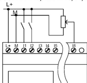
Входы приборов объединены в одну группу, связанную общим проводом (M). Все дискретные и аналоговые датчики включаются между выводами L+ и M общего блока питания.
