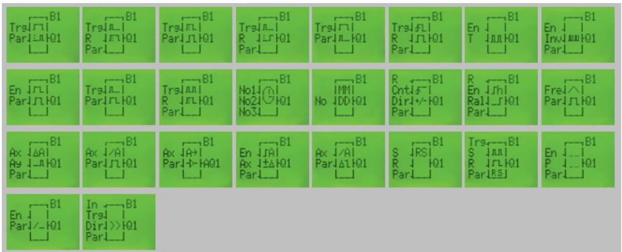
Всего для разработки программ доступно 8 базовых и 26 специальных функций. Общий объем программы ограничен 130 функциями. Это значит, что один модуль LOGO! способен заменить схему, включающую в свой состав до 130 электронных и электромеханических компонентов.
