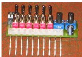
Имитатор предназначен для отладки программ логических модулей LOGO! 12/24RC, LOGO! 12/24RCo, LOGO! 24 и LOGO! 24o. Он выполнен в виде платы с жесткими выводами для подключения к входам логического модуля и оснащен 6 переключателями для формирования входных дискретных сигналов, а также двумя потенциометрами для формирования входных аналоговых сигналов 0...10В. Питание на имитатор подается от логического модуля.
