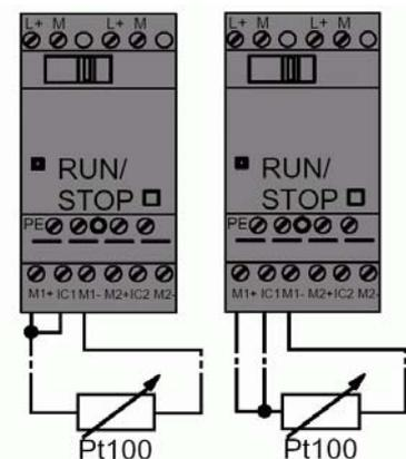
Поддерживаются варианты 2- (слева) и 3-проводного подключения датчиков Pt100. Экраны кабелей подключаются к клеммам PE.
