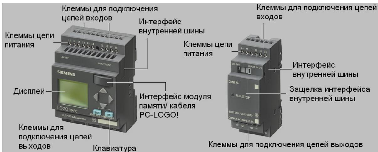
Все модули семейства LOGO! выпускаются в компактных пластиковых корпусах, предназначенных для установки на стандартные 35 мм профильные шины DIN. На верхней части корпуса расположены клеммы для подключения цепи питания, а также датчиков или органов ручного управления. На нижней части корпуса расположены клеммы для подключения нагрузки (реле, контакторов, соленоидных вентилей и т.д.).
