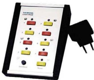
Программатор LOGO! PROM позволяет тиражировать запрограммированные модули памяти LOGO!. За один цикл он позволяет записывать программу в восемь модулей памяти. Программирование может выполняться двумя способами:
