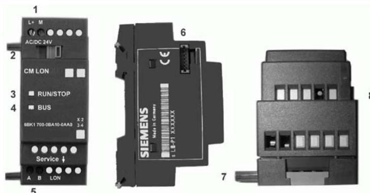
Все модули LOGO! монтируются на 35 мм профильную шину DIN или на плоскую поверхность. Объединение всех модулей в единое устройство осуществляется через внутреннюю шину. В линейке модулей расширения модуль LOGO! CM LON должен устанавливаться последним.
