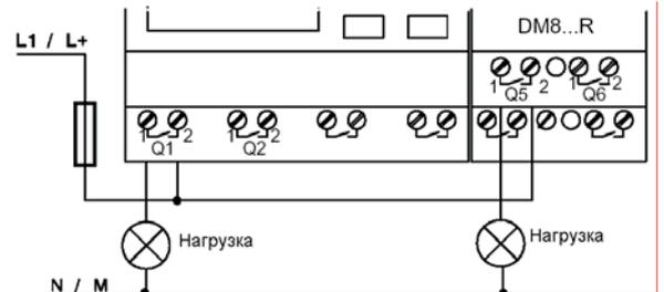
Выходы выполнены в виде изолированных друг от друга контактов реле. Для питания нагрузки необходим внешний источник питания. Цепь питания нагрузки рекомендуется защищать 16А автоматическим выключателем с характеристикой В16 (например, 6SX2 116-6).
