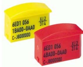
Модули памяти LOGO! предназначены для длительного хранения программ и данных, переноса программ с одного логического модуля на другой, сохранения данных при перебоях в питании логических модулей. Запись информации в модуль памяти осуществляется непосредственно из памяти логического модуля или с использованием программатора LOGO! PROM.
