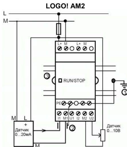
Клеммы PE используются для подключения заземления (1) и экранов соединительных кабелей (2).
