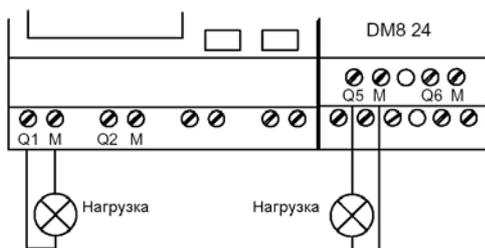
Питание на транзисторные выходы поступает непосредственно из модуля. Специальный блок питания нагрузки не нужен. Выходы оснащены защитой от коротких замыканий и перегрузки. Максимальная нагрузка на каждый выход составляет 0.3А при напряжении =24В.
