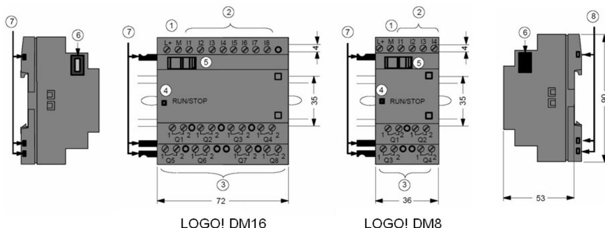
Модули LOGO! DM выпускаются в пластиковых корпусах размерами 36x52x90 или 72x52x90 мм и имеют степень защиты IP 20. На их корпусах расположены:
