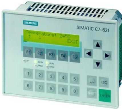
Функционально законченные системы автоматизации, объединяющие в своем составе программируемый контроллер и панель оператора:
