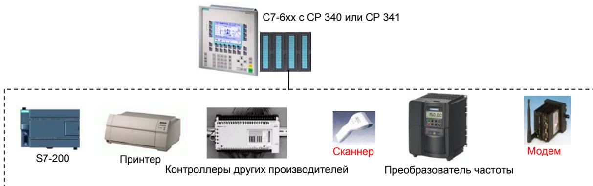
В CP 340 и CP 341 могут использоваться последовательные интерфейсы TTY (20mA токовая петля); RS 232C/V.24 или RS 422/RS485. Поддерживаемые протоколы и скорость передачи данных определяются типом коммуникационного процессора, типом используемого последовательного интерфейса и используемым программным обеспечением. В комплект поставки коммуникационных процессоров входят руководства и специальные функциональные блоки для реализации функций связи.
