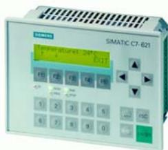
Система SIMATIC C7-621 предназначена для построения простых систем автоматического управления высокого быстродействия, предъявляющих относительно простые требования к системе человеко-машинного интерфейса. Она объединяет в своем составе центральный процессор CPU 314 и панель оператора OP3.
