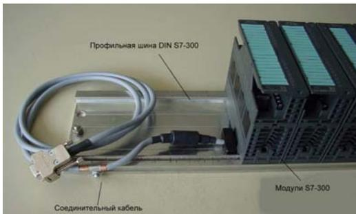
Третий вариант расширения требует применения соединительного кабеля 6ES7635-0AA00-6CA0 длиной 1,5 м. С помощью этого кабеля к блоку управления C7 может подключаться до 4 модулей S7-300. Профильная шина для установки модулей S7-300 должна заказываться отдельно.
