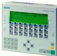
Системы SIMATIC C7-634 по своим характеристикам близки к системам C7-633, но способны поддерживать более полный набор функций человеко-машинного интерфейса. SIMATIC C7-634 объединяют в своем составе центральный процессор CPU 315 или CPU 315-2DP и панель оператора OP17.
