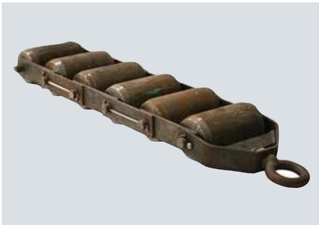
Контрольные роликовые цепи используются для калибровки конвейерных весов в тех случаях, когда проверки на материалах непрактичны. Все контрольные цепи снабжены втулками. Минимальная длина — 4 фута (1,2 м).
