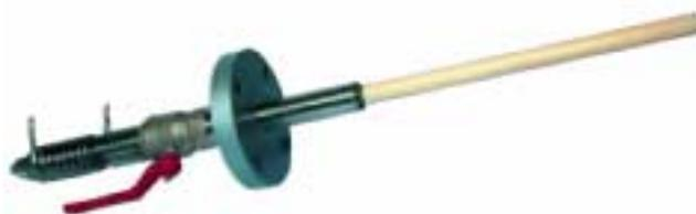
Прибор с керамической трубой используется для измерений в печах. Пирометр измеряет температуру дна керамических изделий. Комплект крепится с наружной стороны печи с помощью съёмного фланца. Для защиты от выхода печных газов предусмотрен сферический кран. Устройство охлаждения может быть заполнено воздухом или водой. Устройство охлаждения позволяет использовать пирометр при повышенной температуре окружающей среды.
