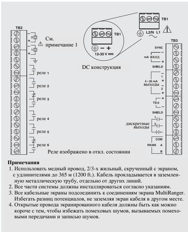
Рис 4/24 Схема соединения MultiRanger
