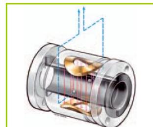
*Катушки в датчике генерируют однородное магнитное поле. Жидкость, протекающая через датчик, индуцирует напряжение, пропорциональное скорости потока.*
