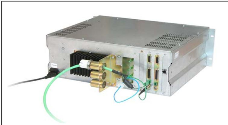
Подключение сенсоров к преобразователю производится с помощью оптоволоконного кабеля. Максимальная длина кабеля может составлять до 1000 м. К одному преобразователю может быть подключено до 3х сенсоров. Преобразователь имеет стандартный 19-дюймовый корпус, предназначенный для щитового монтажа.
