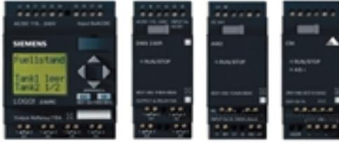
Для программирования модулей используются самые распространенные на практике логические функции, в том числе шесть базовых (AND, OR, NOT, NAND, NOR, XOR), а также ряд специализированных функций (задержка включения и выключения, импульсное реле, выключатель с часовым механизмом, реле с самоблокировкой, тактовый генератор и др.).
