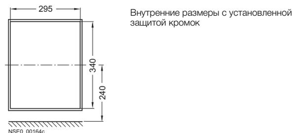
Внутренние размеры с установленной защитой кромок
