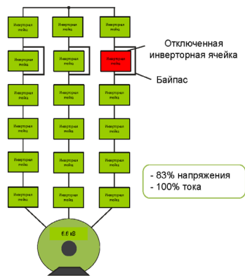
Принцип работы байпаса ячейки
