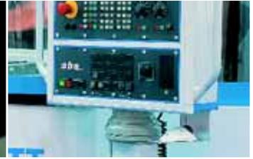
При взгляде на машину под различными углами командная панель с системами несущих рычагов Rittal всегда занимает оптимальную позицию – независимо от
