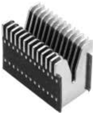
Увеличенная дугогасительная камера позволяет разбить электрическую дугу на большое количество маленьких дуг, тем самым быстрее ее погасить.
