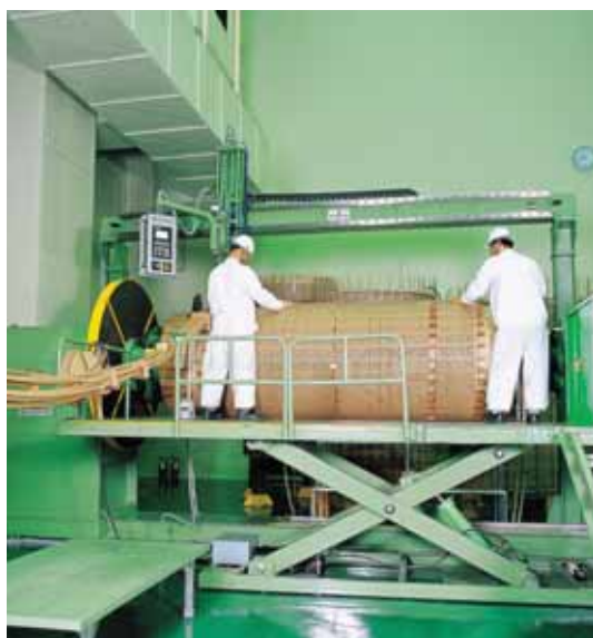
Горизонтальный станок для укладки обмоток
