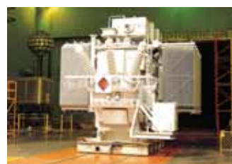
Трансформатор 66кВ/ 20МВА Токийская Электрэнергетическая Компания в Японии.
