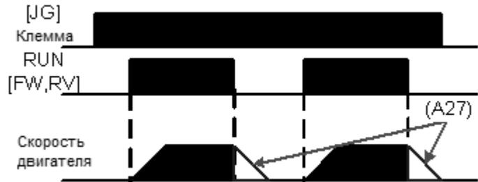
Тип замедления, используемый для окончания толчкового режима двигателя, можно выбрать путем программирования функции [A27] Опции следующие:
