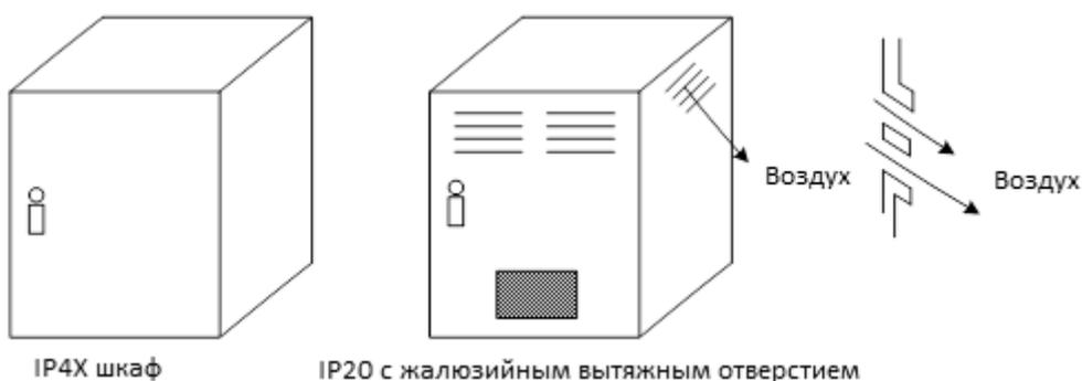
Рис 1. ШКАФ ИНВЕРТОРА
