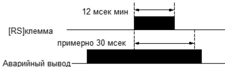
• Для выполнения команды [RST] необходима подача входного длительного импульса 12 мс и более. Выход аварийного сигнала будет очищен в течение 30 мс после ввода команды «Сброс».
