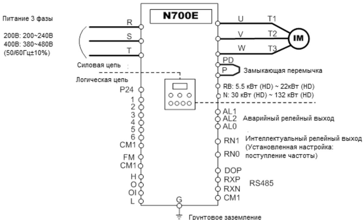
Рис. 3-2 Схема настройки с панели оператора
