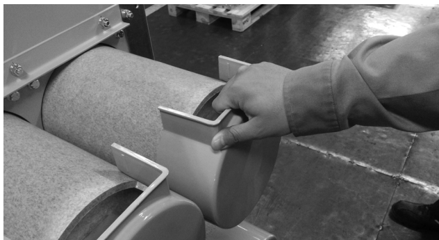
Fig. 3-2 Bushing cover inspection / Рис. 3-2 Проверка крышки изолятора
