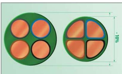
Кабели серии **RV-K FOC 0,6/1кВ** сечением от **50 мм<sup>2</sup>** производятся в версии **«SECTORFLEX»** с многопроволочными проводниками в форме радиального сектора. Важным преимуществом кабеля с секторными проводниками, являются **уменьшение внешнего диаметра до 12%** и **снижение веса до 11%** за счёт лучшего использования пространства между проводниками и уменьшения веса пластика.
