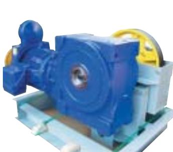
Getriebe für 6000kg Nutzlast, Aufhängung 2:1 Nutzlast, Zusatzbremse als Schutzeinrichtung gegen Übergeschwindigkeit des aufwärtsfahrenden Fahrkorbes.
