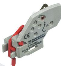
(1) : Микровыключатель автоматически сбрасываемый, указывает наличие предохранителя (PRES) и правильность монтажа. В случае неправильного монтажа или перегорания предохранителя это отображается (клеммы 1-4 замыкаются). Замки 6.3 мм.
