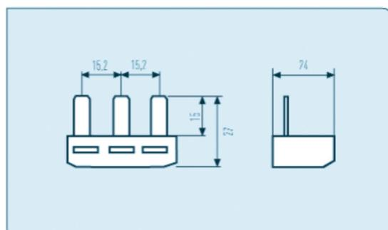
Следующие разрядные модули разработаны для использования с конденсаторами, соединенными параллельно (общая мощность >40квар). В качестве альтернативы, они могут быть использованы для быстрого разряда обычных конденсаторов.
