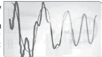
Компенсационные конденсаторы и индуктивности трансформатора и сети представляют собой резонансный контур. Если собственная частота такого контура совпадет с частотой высших гармоник, то возможно возникновение колебаний со значительными сверхтокаами и перенапряжениями. Это ведет к перенагрузкам и повреждениям в электрических установках. Загрязнение сетей переменного тока высшими гармониками может вести к следующим последствиям:
