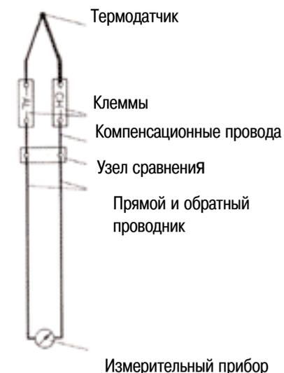
Клеммы предназначены для работы с очень низким потенциалом термоэлементов. Материал токовых шин выбирается аналогичным материалу термопары, чтобы уменьшить до минимума искажение термо э. д. с. На каждую термопару необходим двухполюсный блок. Материал токовых шин указан на корпусе клеммы.
