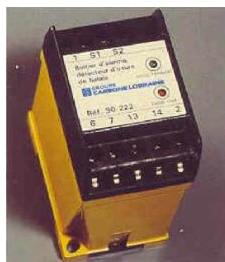
Свободный конец этой оплётки связан с средством соответствующего соединения к схеме сигнального устройства звукового или светового, который закрывается щёткой на коллекторе посредством 2 реле. Когда из-за износа щётки, провод сигнального устройства переходит к контакту коллектора, из этого не вытекает никакого повреждения для токопроводящего элемента. Это короткое замыкание пускает в ход сигнальное устройство.
