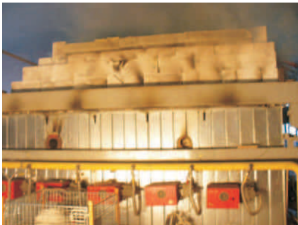
Огневая камера, предназначенная для тестов, согласно DIN 4102-12
