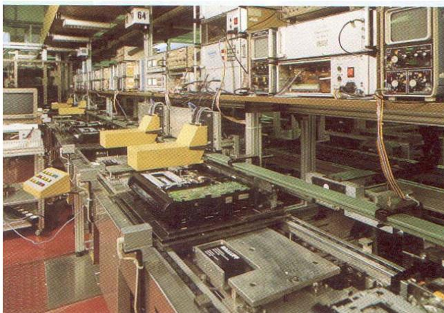
Производство видеомagneтофонов Grundig, где система идентификации BIS играет значительную роль. С помощью систем идентификации BIS возможно реально снизить общезаводские накладные расходы почти на 30 % (в сравнении с использованием обычных систем). Кроме того, снижаются также и дефекты производства.
