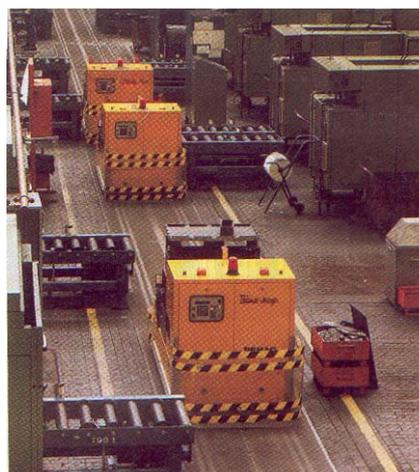
Контролирование движения автоматически управляемых тележек с использованием BIS F
