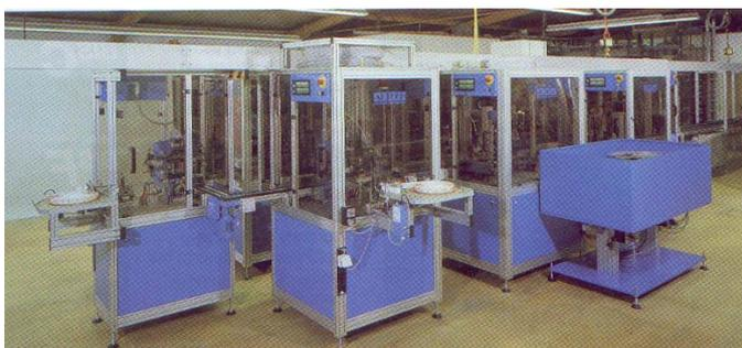
Контролирование производственного процесса при сборке фар с использованием BIS F
