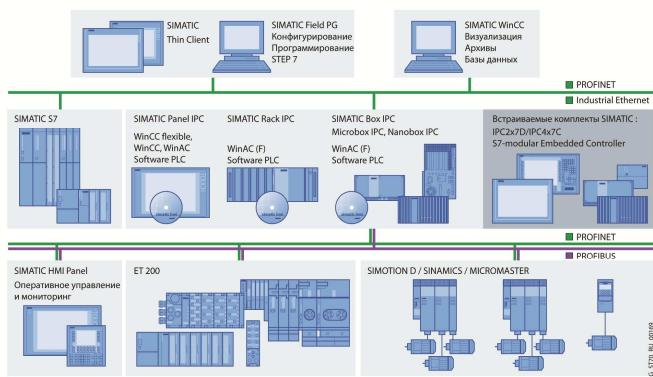
Программное обеспечение SIMATIC WinAC RTX (F), инструментальные средства проектирования STEP 7 и программное обеспечение визуализации могут устанавливаться на один или на разные компьютеры. В первом случае обмен данными между всеми перечисленными приложениями выполняется на локальном уровне компьютера, во втором через промышленные сети PROFINET/ Ethernet или PROFIBUS.
