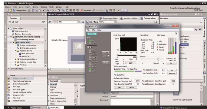
Связь с автоматизируемым оборудованием поддерживается через интерфейс PROFIBUS DP и/или PROFINET IO компьютера/контроллера S7-mEC. При использовании интеллектуальных коммуникационных процессоров (CP 5603, CP 5613 A2, CP 5623) к одному компьютеру может быть подключено до четырех систем распределенного ввода-вывода на основе сети PROFIBUS DP или до трех систем на основе PROFIBUS DP и одна на основе PROFINET IO.
