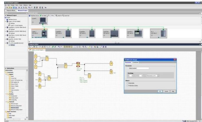
Программное обеспечение LOGO! Soft Comfort V8.0 (LSC) предоставляет наиболее гибкие и широкие возможности по разработке, отладке, документированию и архивированию программ логических модулей LOGO! всех поколений. Дополнительно этот пакет позволяет конфигурировать сетевые соединения логических модулей последних поколений.
